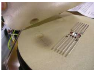
Le point d'échauffement est visible sur l'écran inducteur.
