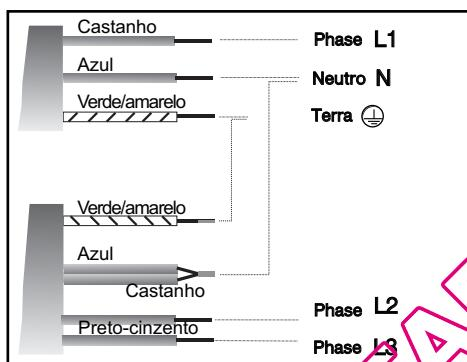
Quando se liga a placa à corrente trifásica de 400V2N, em caso de anomalia verifique se o fio do neutro está bem conectado. Estas precauções também são válidas para os outros aparelhos electrónicos que possui.
