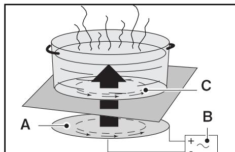
**A - Inductor****B - Circuito electrónico****C - Corrientes inducidas**
