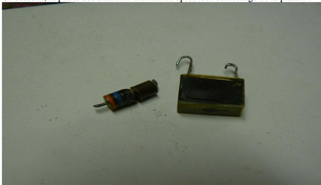
Sur cette photo, on constate que la résistance a été littéralement sectionnée en 2 et que le condensateur est légèrement boursoufflé et noirci voire éclaté sur une face.
