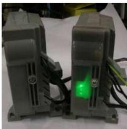
Fig. 8.2.1/ 1 Onduleur avec LED de diagnostic
