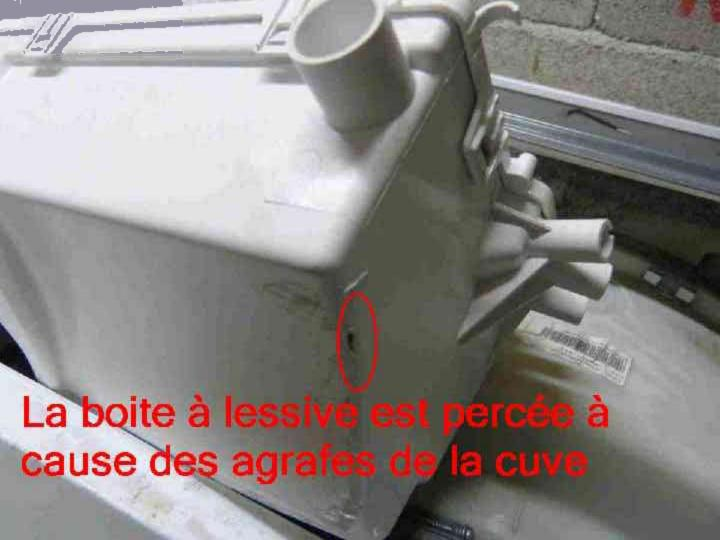
Fixation cassée à cause du ballant de la cuve du à une mauvaise conception et réglage de la cuve dés l'achat Ensuite, la boite se crève, l'eau coule sur le pied de vérin amortisseur qu rouille, et le ballant s'amplifie, la machine fait des bonds à l'essorage, en plus de la fuite
