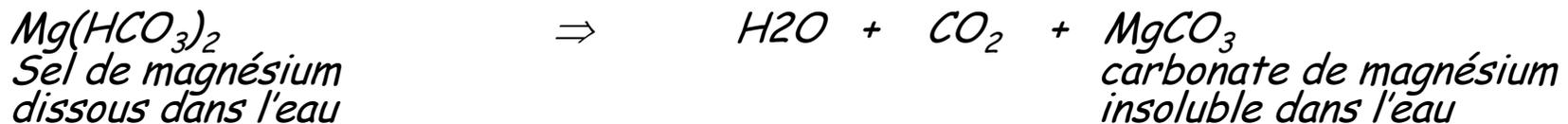
*La dureté de l'eau ou Titre Hydrotimétrique (TH) est la teneur en carbonate de calcium  $\text{CaCO}_3$  dont l'unité internationale est le milliéquivalent par litre (meq/l). En France on utilise très souvent le degré français de dureté °F.*
