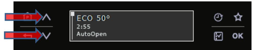
Une fois en mode Maintenance, utilisez les touches de navigation pour sélectionner une des fonctions de maintenance affichées et utilisez la touche « OK » pour entrer dans la fonction sélectionnée. Suivez ensuite les instructions qui s'affichent pour exécuter les fonctions.
