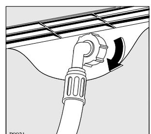
Si nécessaire rectifiez la position du raccord de vidange en dévissant la bague de serrage placé à l'arrière de l'appareil.
