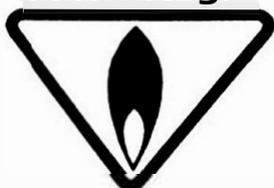
Ce dispositif de sécurité directement lié au fonctionnement interrompt automatiquement l'arrivée du gaz en cas d'extinction accidentelle de la flamme.
