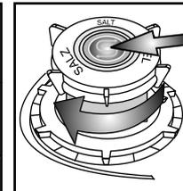
Vissez le bouchon. Éliminez les résidus de sel autour du bouchon. Certains réservoirs à sel ont un indicateur de niveau intégré dans le bouchon (voir comment contrôler ci-dessous).
