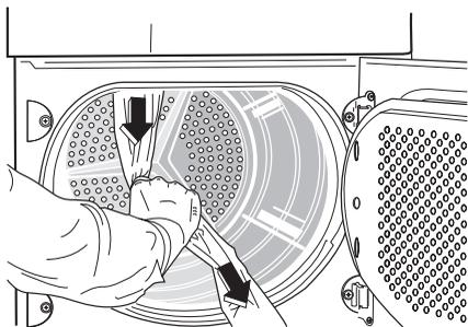
3. Enlevez la gaine plastique avec le rembourrage en polystyrène de l'appareil.
