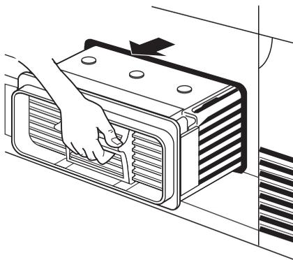
3. Nettoyez-le avec une brosse et rincez-le sous l'eau courante. Nettoyez également l'extérieur en éliminant toutes les peluches. Nettoyez le joint en caoutchouc autour du condenseur et l'intérieur du volet à l'aide d'un chiffon humide.
